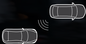
Hệ thống cảnh báo điểm mù BSM (Blind Spot Monitoring)
